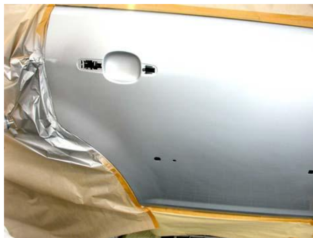
Рис. 8: Дверь покрыта базой без слоя лака
