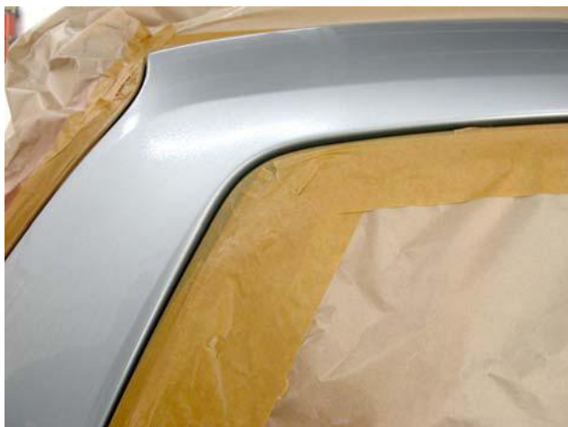
Рис. 13: Разбавитель, нанесенный распылением
