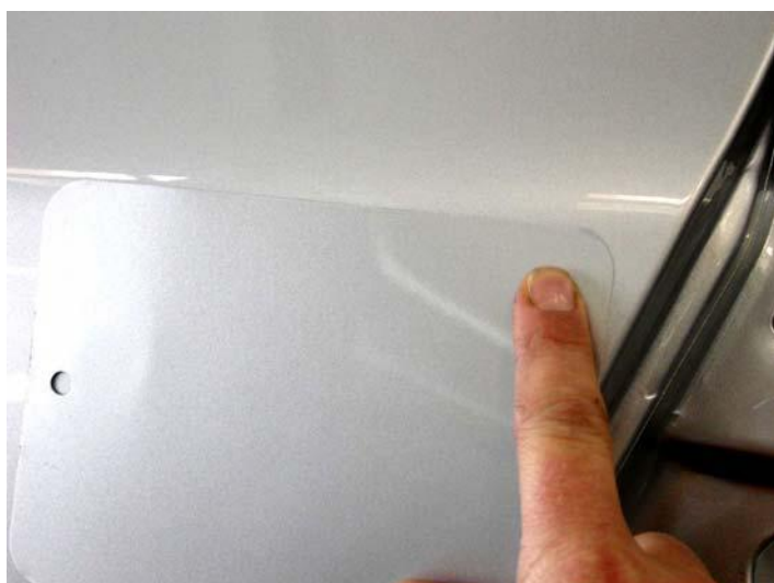
Рис. 6: Сравнение образца с оригинальным цветом ЛКП автомобиля
