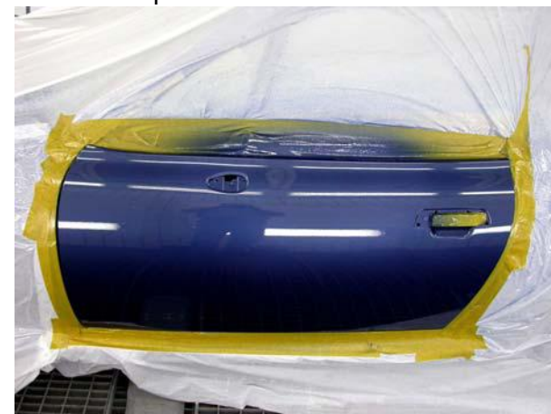
Рис. 17: Прозрачный лак. 1-е нанесение Рис. 18: Дверь после нанесения лака в готовом виде
