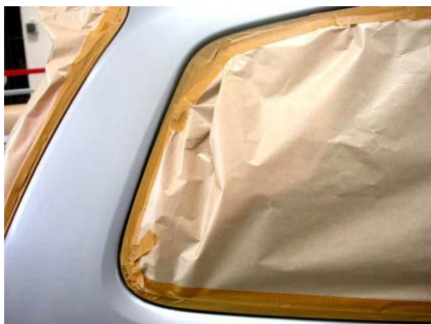
Рис. 11: Матирование задней стойки
