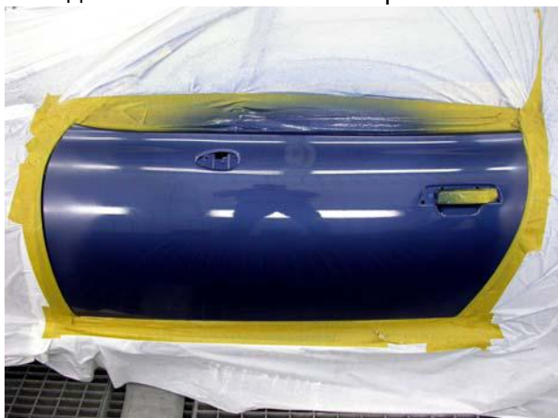
Рис. 17: Прозрачный лак. 1-е нанесение Рис. 18: Дверь после нанесения лака в готовом виде
