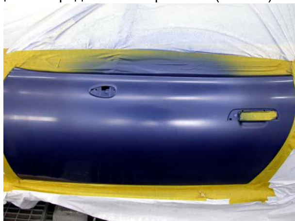
Рис. 15: Точечное нанесение наполнителя Рис. 16: Частичная окраска базовым лаком
