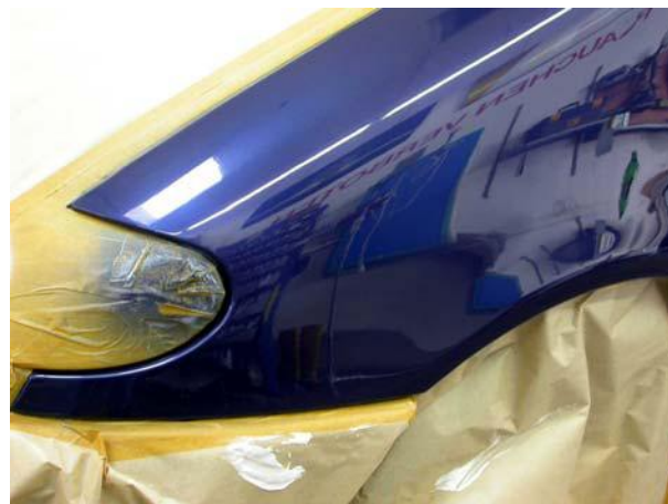
Рис. 24: Шлифовка зоны перехода
