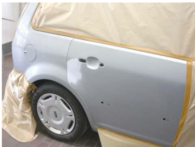
Рис. 7: Ремонтная дверь и заднее крыло
