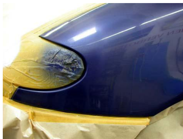
Рис. 22: База частично покрыта лаком
